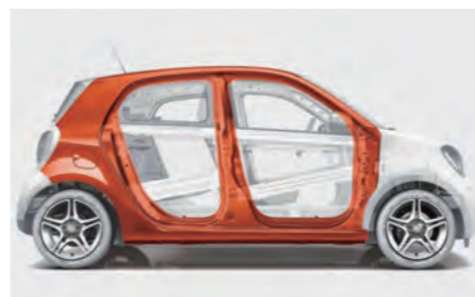
トリディオンセーフティセル。強固な高強度スチールの使用比率を高めることであらゆる方向からの衝突時に乗員を保護します。
