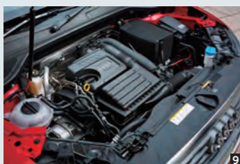
8 999cc直列3気筒DOHCインタークーラー付ターボエンジンは、85KW(116PS)の最高出力と2000~3500rpmの最大トルクを発生。
