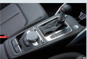
10 従来から好評を得ていた7速SトロニックAT。マニュアル操作にも対応しており、モードもDとSの2種類から選択可能。
