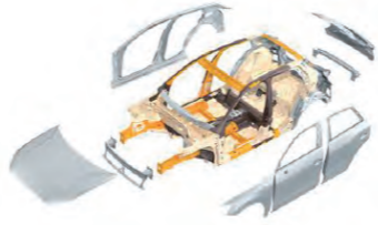
4 軽量で高いボディ剛性により、スポーティーなハンドリングと快適な乗り心地の両立が可能になっている。
